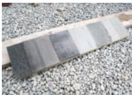
下地から仕上げまでの工程見本。ひび割れ対策に万全を期した。
