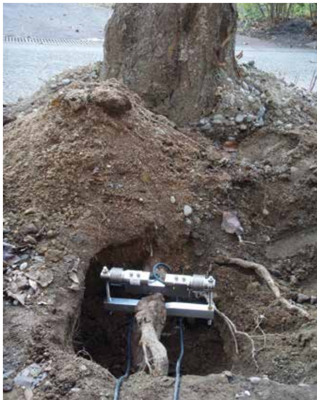
▲ソメイヨシノの根の肥大力測定装置の設置状況
