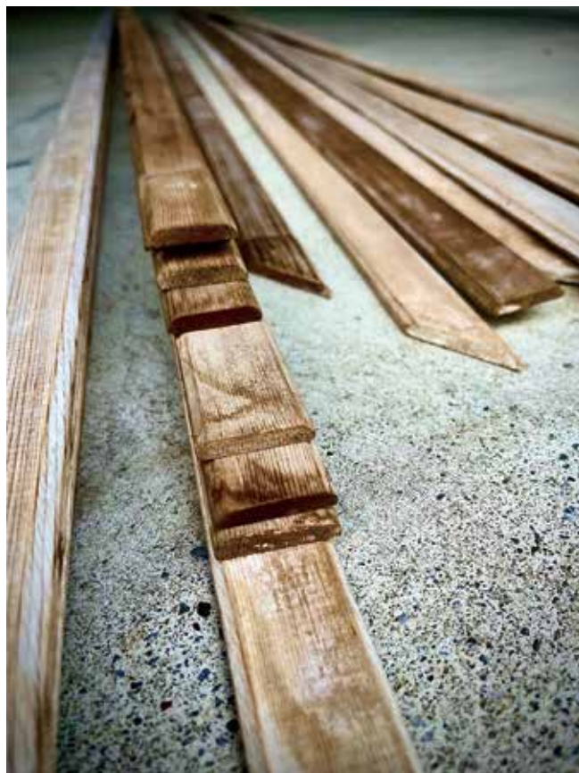
▲漆喰定規。幅1寸、長さ6寸、厚み2分。
