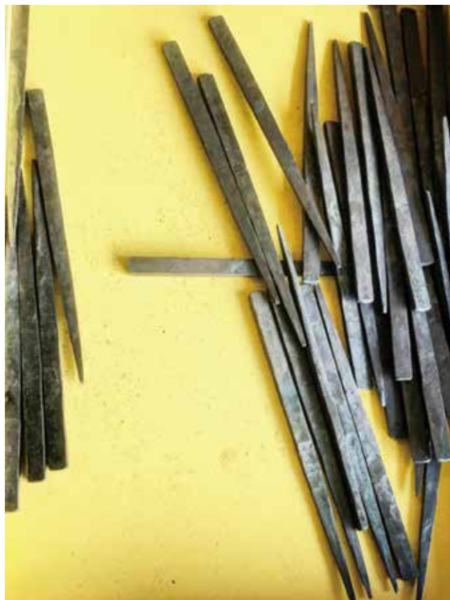
▲和釘 本鍛造頭無し釘 阿弥陀釘に使用。指図から長さを割り出し、注文する。
